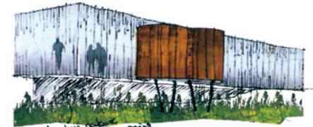
*Structure bois + remplissage paroi de béton + peinture*
